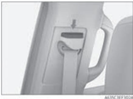
При сравнительно близком расстоянии ремня безопасности от щеки или при соскальзывании ремня с плеча, можно отрегулировать высоту ремня безопасности с помощью ре-
