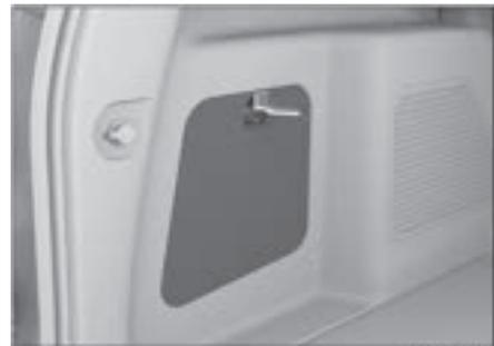
Предохранители можно увидеть, сняв крышку блока предохранителей.
