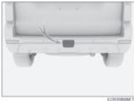
Разъем тягово-сцепного устройства расположен посередине задней поперечины рамы. Его можно увидеть, открыв крышку в середине заднего бампера.
