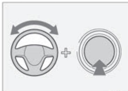
Если при переключении режимов или запуске двигателя на информационном дисплее отображается информация о неуспешной разблокировке рулевой колонки, необходимо слегка повернуть рулевое колесо вправо, затем влево, одновременно нажимая на выключатель зажигания, чтобы снять блокировку.
