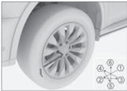
С помощью ключа для колесных гаек слегка открутите гайки против часовой стрелки в порядке, показанном на рисунке (примерно на 1 оборот).
