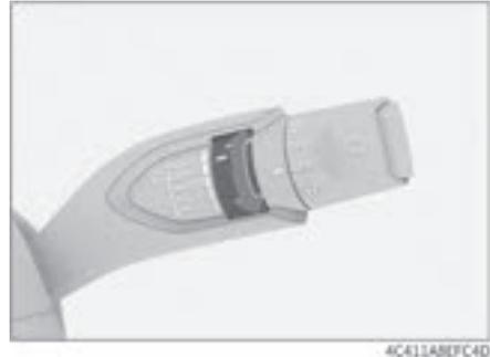
Поворотом кнопки регулировки можно изменить чувствительность датчика дождя и освещенности к силе дождя. Таким образом изменится частота работы передних стеклоочистителей в автоматическом режиме.
