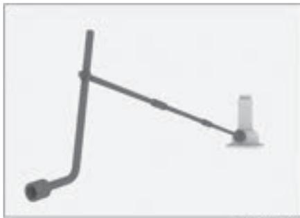
Объедините переднюю, среднюю и заднюю секции воротка подъемного механизма запасного колеса с ключом для колесных гаек, как показано на изображении. Затем вставьте вороток подъема запасного колеса в отверстие в верхней части домкрата.
