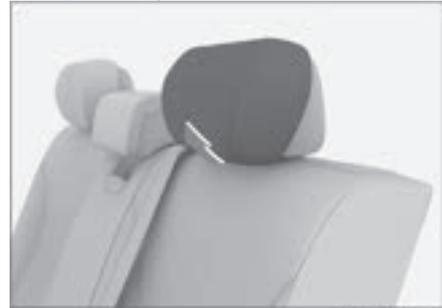
Угол наклона можно регулировать, потянув вперед нижнюю часть аэроподголовника.
