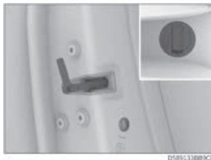
Вставьте механический ключ в отверстие аварийного замка двери, поверните отверстие замка в направлении стрелки на отверстии аварийного замка и закройте дверь, чтобы заблокировать ее.
