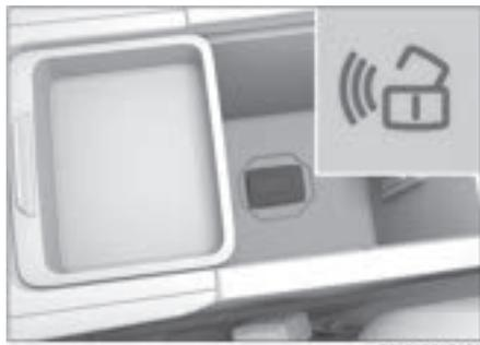
Если появляется запрос «Находится ли ключ в салоне?» (например: смарт-ключ разряжен, серьезно поврежден дверной щиток или задний бампер), поместите смарт-ключ на отметку в подстаканнике для выполнения обычного запуска транспортного средства. Выполните обычный запуск двигателя. Если двигатель по-прежнему не запускается, обратитесь в сервисный центр.
