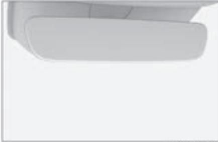
Внутреннее зеркало заднего вида автоматически уменьшает отраженный свет в зависимости от интенсивности света фар автомобиля, находящегося сзади.
