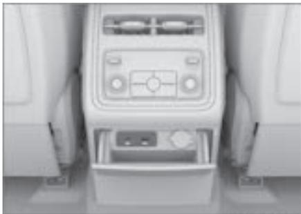
Задний блок питания USB расположен в ящике для хранения в задней части дополнительной приборной панели. Для использования сначала нажмите на ящик для хранения, чтобы открыть его. Когда режим питания включен, этот источник питания можно использовать для зарядки энергоемких устройств, таких как мобильные телефоны и планшеты.
