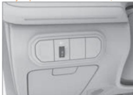
Передний свет регулируется в зависимости от количества пассажиров и загрузки автомобиля. Высота светового луча.
