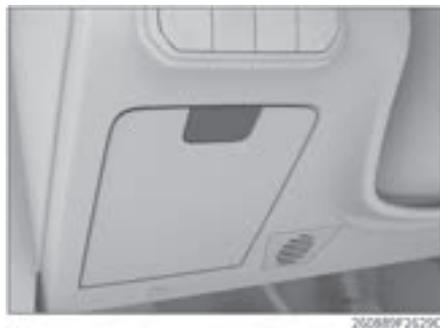
Для использования нажмите на выключатель, и ящик для хранения откроется автоматически.
