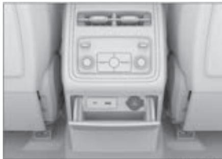
Задний источник питания 12 В расположен в ящике для хранения в задней части вспомогательной приборной панели. Для использования сначала нажмите на ящик для хранения, чтобы открыть его. Когда режим питания включен, этот источник питания обеспечивает питание 12 вольт постоянного тока для аксессуаров мощностью менее или равной 120 Вт (10 ампер).
