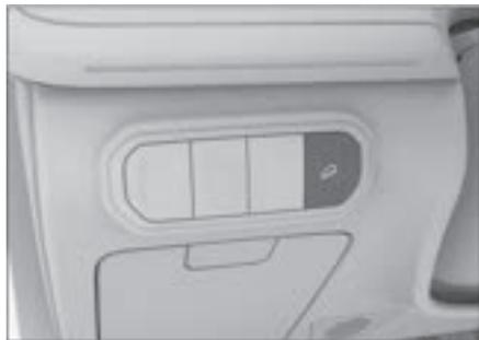
При включенном режиме питания или заведенном автомобиле систему HDC можно включить или выключить нажатием кнопки.
