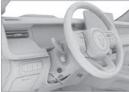
Поверните ручку регулировки в направлении стрелки, отрегулируйте рулевое колесо так, чтобы оно находилось на одной линии с вашей грудью, и убедитесь, что вы видите все датчики и индикаторы на приборной панели.
