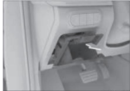
Предохранитель можно увидеть, сняв отделение для мелких предметов (крышку блока предохранителей), как показано на рисунке. Не рекомендуется самостоятельно снимать отделение для мелких предметов, если в этом нет необходимости. Поскольку демонтаж отделения требует определенного уровня квалификации, поручите этот процесс сервисному центру.
