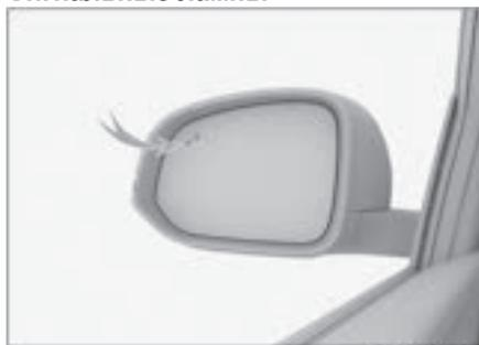
Предупреждающие сигнализаторы расположены на зеркальных элементах левого и правого наружных зеркал заднего вида.
