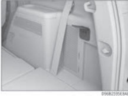
Блок питания 220 вольт расположен на правой панели в багажном отделении. Следует использовать при заведенном автомобиле, при использовании просто откройте крышку. Этот источник питания может обеспечить переменное напряжение 220 вольт для аксессуаров мощностью менее или равной 400 Вт.
