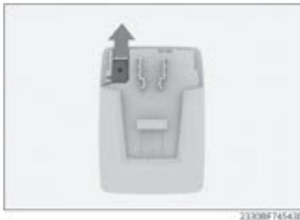
3. Поверните ручку механического ключа в положение для его использования.
