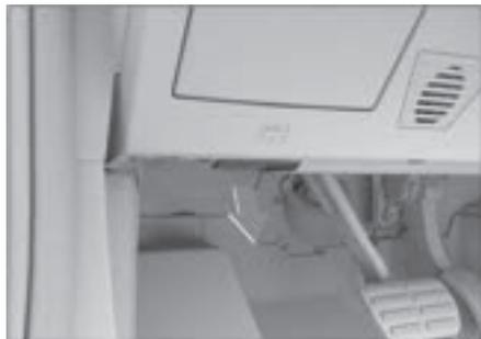
2. Просуньте руку в щель и потяните ручку влево, поднимите капот, который после этого автоматически поднимется в открытое положение.
