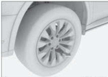
В автомобилях, оснащенных декоративными колпачками гаек, сначала при помощи специального инструмента необходимо последовательно снять декоративные колпачки с колесных гаек.
