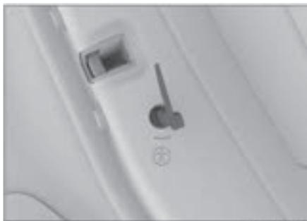
Детский замок можно заблокировать, вставив механический ключ в отверстие замка и повернув его в направлении, указанном на рисунке. Детский замок можно разблокировать, повернув его в противоположном направлении.
