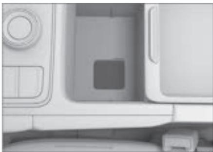
5. Поверните рукоятку разблокировки передачи Р против часовой стрелки примерно на 60 градусов, чтобы она вошла в паз.
