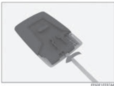
3. Проверьте полярность элемента питания и извлеките его. Соблюдая полярность, вставьте новый элемент питания в слот
