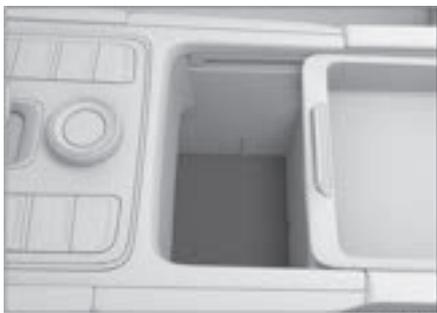
4. В выемке с помощью плоской отвертки, обернутой тканью, подденьте крышку, чтобы открыть доступ к рукоятке разблокировки передачи Р.
