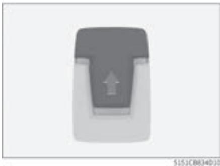
2. Выдвиньте механический ключ наружу и извлеките его.
