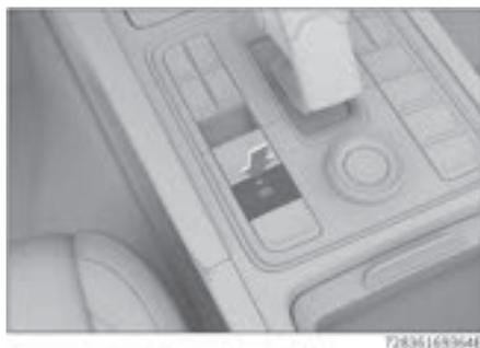
Для включения или выключения функции нажмите на выключатель AVH при закрытой двери водителя, пристегнутом ремне безопасности и включенном двигателе.
