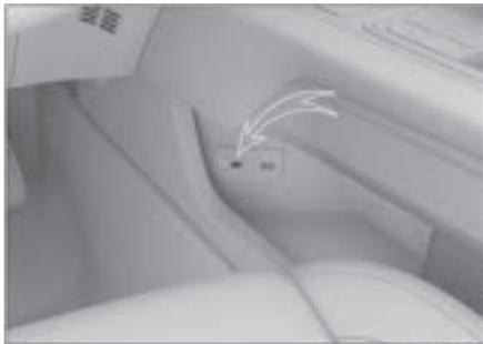
Передний блок питания USB типа С расположен в углублении на левой стороне вспомогательной приборной панели. Когда режим питания включен, этот источник питания можно использовать для зарядки энергоемких устройств, таких как мобильные телефоны и планшеты.
