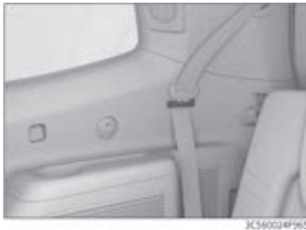
Когда ремень безопасности не используется, его можно зафиксировать в зажиме, чтобы не мешать регулировке сиденья и складыванию спинки (в автомобилях, оснащенных зажимами для ремней безопасности).
