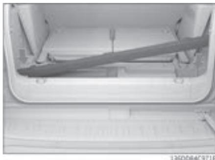
Расположив кнопку фиксатора шторки вверх, а шторку - лицом к передней части автомобиля, установите сначала левую сторону, а затем правую.
