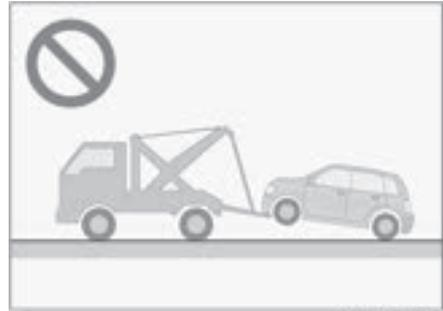
Использовать погрузчик с лебедкой для буксировки запрещается, в противном случае можно легко повредить корпус автомобиля.
