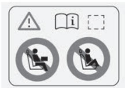
Наклейки расположены на центральной стойке и предназначены для информирования о том, что автомобиль оснащен боковыми подушками безопасности и что необходи-
