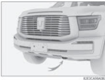
Передний буксировочный крюк расположен в передней части ходовой.
