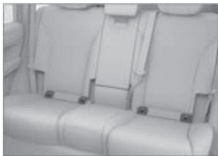
Между спинкой и подушкой задних сидений расположены четыре нижних точки крепления ISOFIX. Если на нижних точках крепления установлена декоративная крышка, ее необходимо снять перед использованием.
