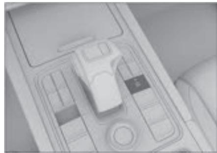
1. Нажмите кнопку круиз-контроля при движении по пересеченной местности, расположенную рядом с рычагом переключения передач, для включения функции круиз-контроля при движении по бездорожью. Нажмите кнопку еще раз, чтобы отключить функцию.
