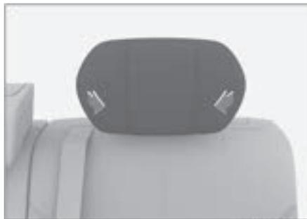
Углы наклона боковых крыльев можно регулировать путем точной регулировки сторон аэроподголовника внутрь или наружу.
