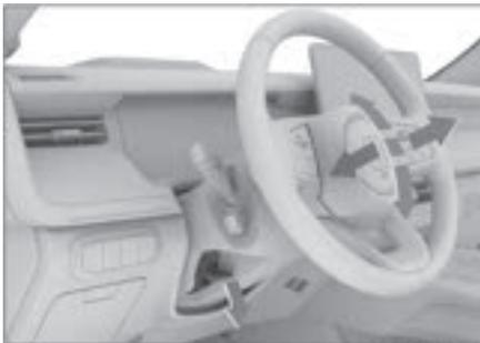
1. Отпустите рычаг регулировки под рулевым колесом.
