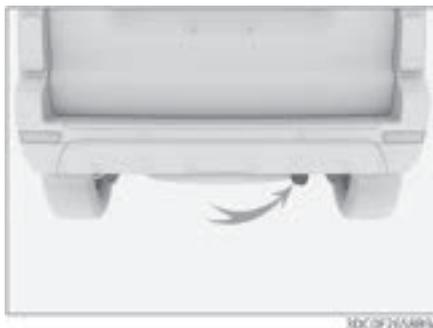
Разъем питания (коннектор) для прицепа расположен с правой стороны заднего бампера. Разъем питания автомобиля - 13-контактный, если коннектор прицепа (буксира) 7-контактный, необходимо приобрести переходник самостоятельно.
