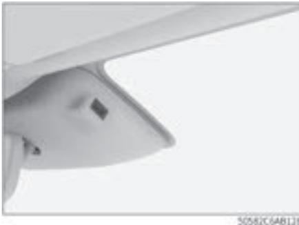
Блок питания автомобильного регистратора расположен возле внутреннего зеркала заднего вида.
