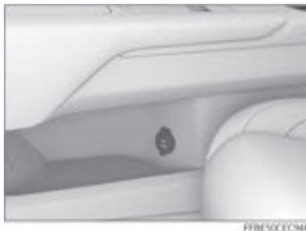
Передний 12-вольтовый источник питания расположен в углублении на левой стороне вспомогательной приборной панели. Когда режим питания включен, этот источник питания обеспечивает питание 12 вольт постоянного тока для аксессуаров мощностью менее или равной 120 Вт (10 ампер).
