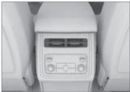
Направление воздушного потока можно регулировать, переключая ручку в центре вентиляционного отверстия.
