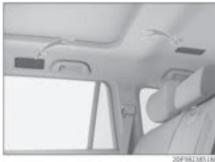
Направление воздушного потока можно регулировать, управляя лепестком в центре отверстия для выхода воздуха.
