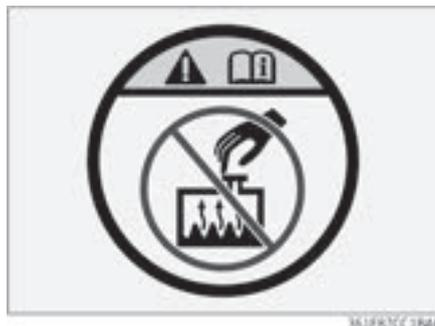
Данный знак расположен на крышке радиатора. Он напоминает, что запрещается открывать крышку радиатора, когда двигатель перегрет. В противном случае существует риск получить сильные ожоги и выплескивания охлаждающей жидкости.
