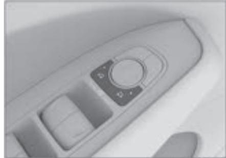
Одновременно нажмите кнопки выбора левого и правого наружных зеркал, наружные зеркала автоматически сложатся. Нажмите кнопки одновременно еще раз, и наружные зеркала заднего вида автоматически раскроются.
